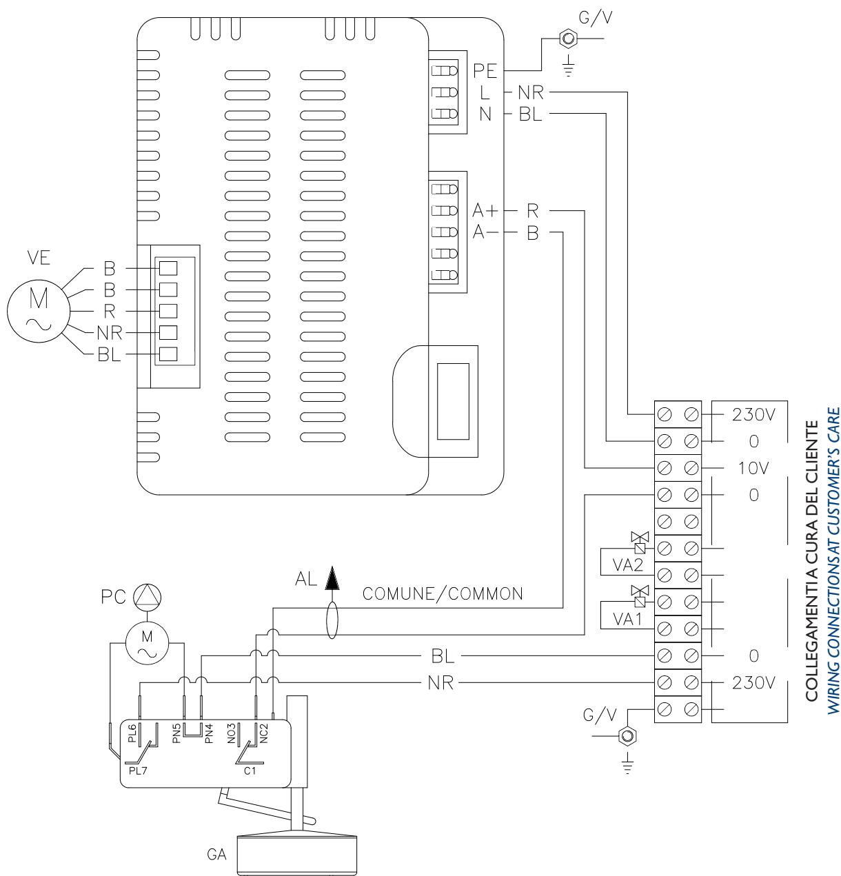
**Schema di collegamento ventilatore/valvole con RAB**
