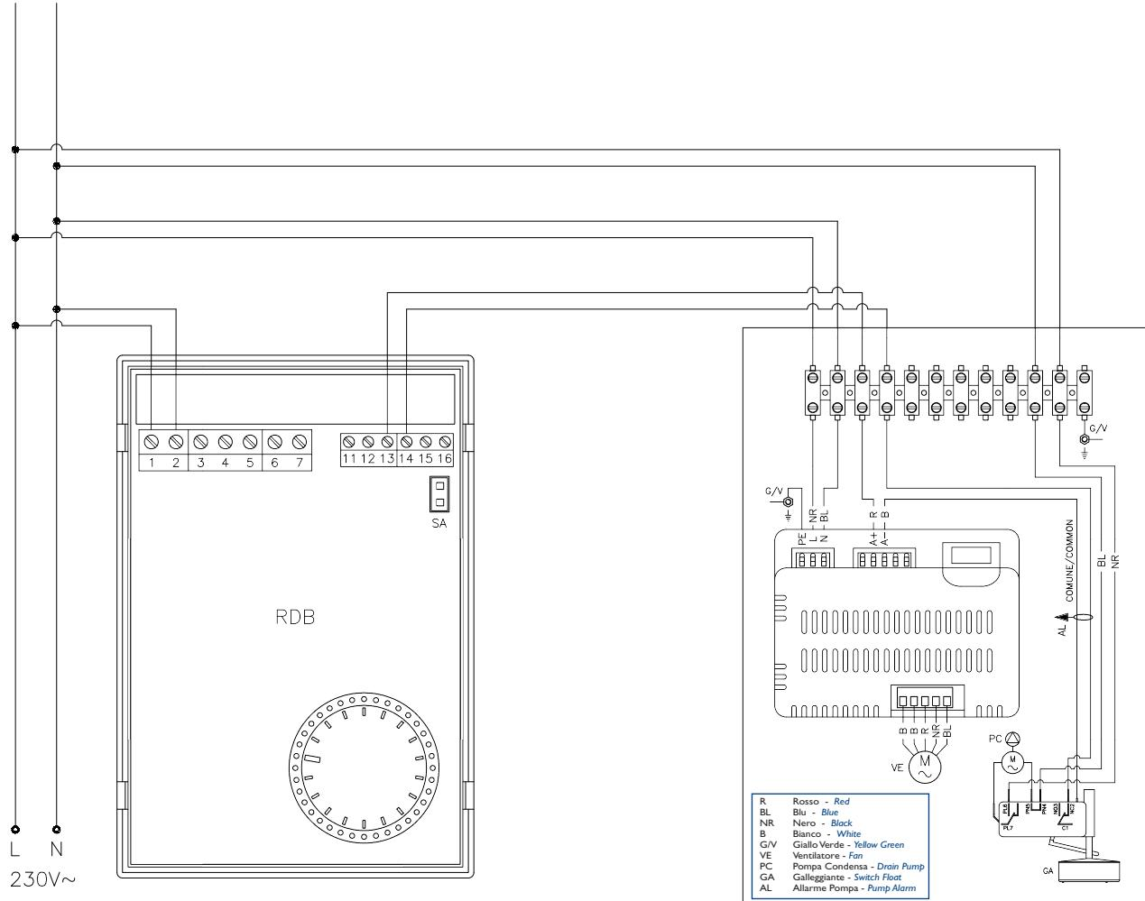
Collegamento valvole ON/OFF per impianto a 2/4 tubi (VC / F x 2T - VC + VF x 4T)
